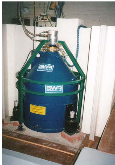
figure 12 : Gravimètre supraconducteur de l'observatoire gravimétrique de Strasbourg
