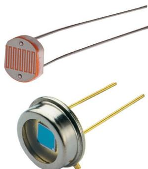
Illustration 40: Photorésistance (en haut) et photodiode (en bas).
