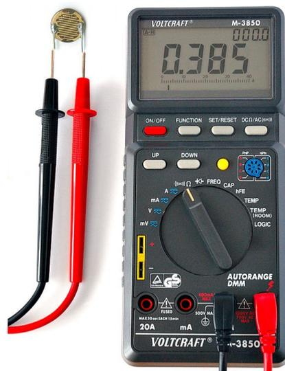
Illustration 39: Principe de mesure de la luminosité à l'aide d'une photorésistance.
