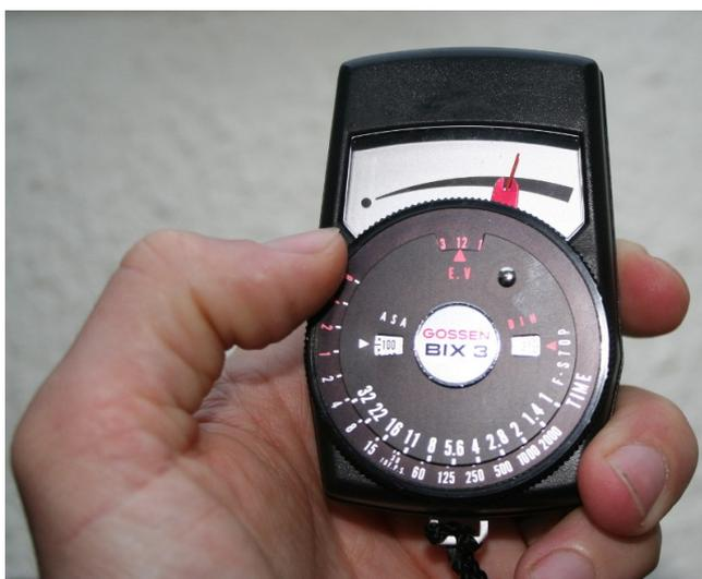
Illustration 38: Utilisation d'un posemètre photographique. L'intensité lumineuse mesurée est ici de 12 EV.
