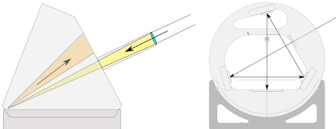
Illustration 33: Principe de fonctionnement du Solarscope (à gauche) et d'ATROS (à droite) qui n'est autre qu'une lunette repliée en trois.
