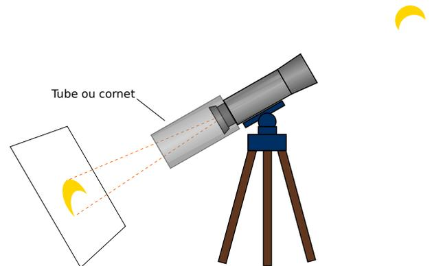
Illustration 34: Principe d'une observation par projection.
