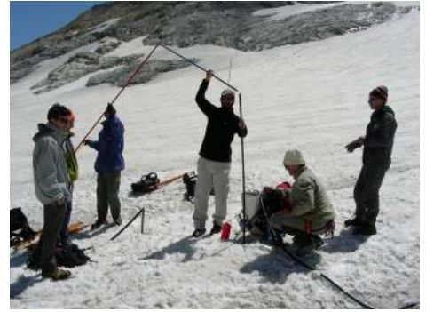
Illustration 12: Pose d'instruments permettant de mesurer la perte d'épaisseur du glacier d'Ossoue. Photo association Moraine.
