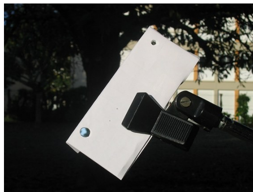
Illustration 29: Exemple de miroir muni de deux sténopés de tailles différentes.
