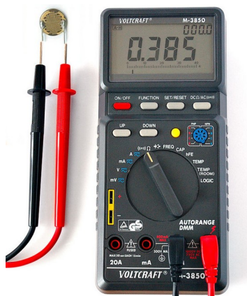
Illustration 38: Principe de mesure de la luminosité à l'aide d'une photorésistance.
