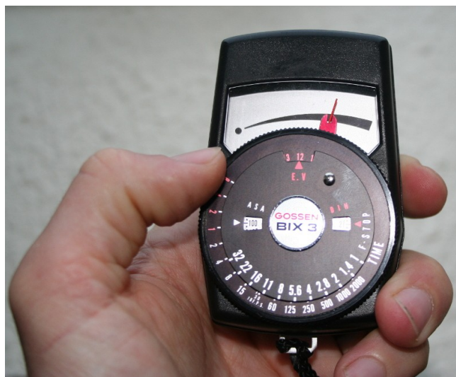
Illustration 37: Utilisation d'un posemètre photographique. L'intensité lumineuse mesurée est ici de 12 EV.
