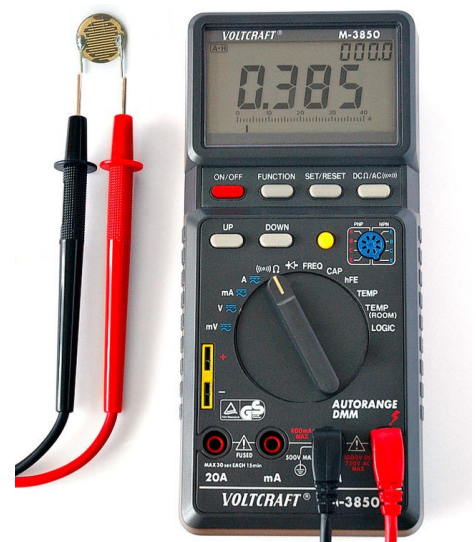
Illustration 38: Principe de mesure de la luminosité à l'aide d'une photorésistance.
