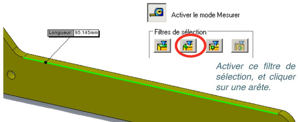
Activer ce filtre de sélection, et cliquer sur une arête.
