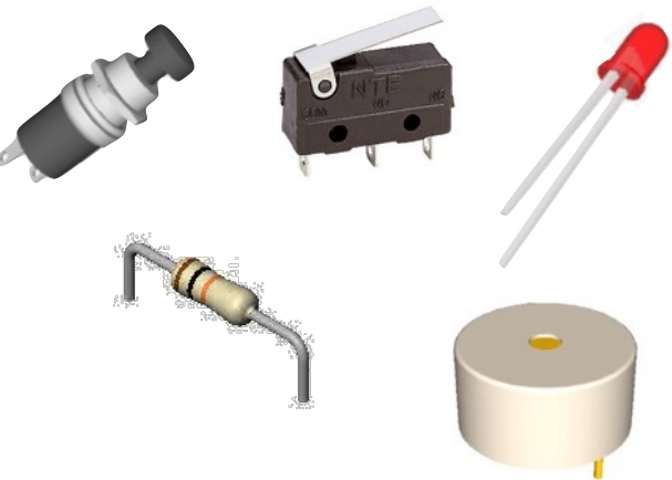
Composants électroniques Type bouton poussoir, capteur fin de course, del, buzzer, résistances 10k et 330 Ohms
