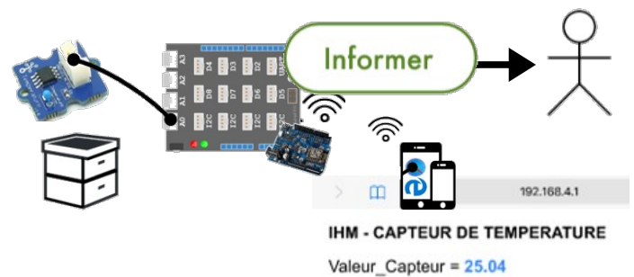
Exemple d'une ruche connectée en wifi : affichage de la température intérieure
