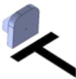
Le robot doit s'arrêter automatiquement au niveau de l'arrivée caractérisée par la butée ( $l=50\text{mm} \times h=50\text{mm}$ ) ou par la ligne perpendiculaire.
